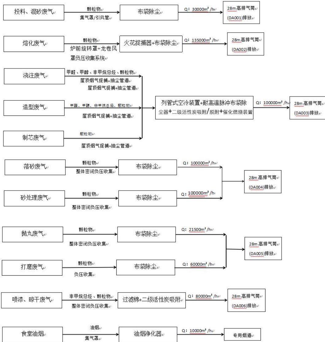
图 4-1 废气收集、处理方式示意图
